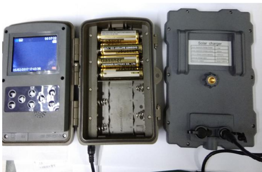
Рис. 5. Підключення камери для полювання для забезпечення живлення
